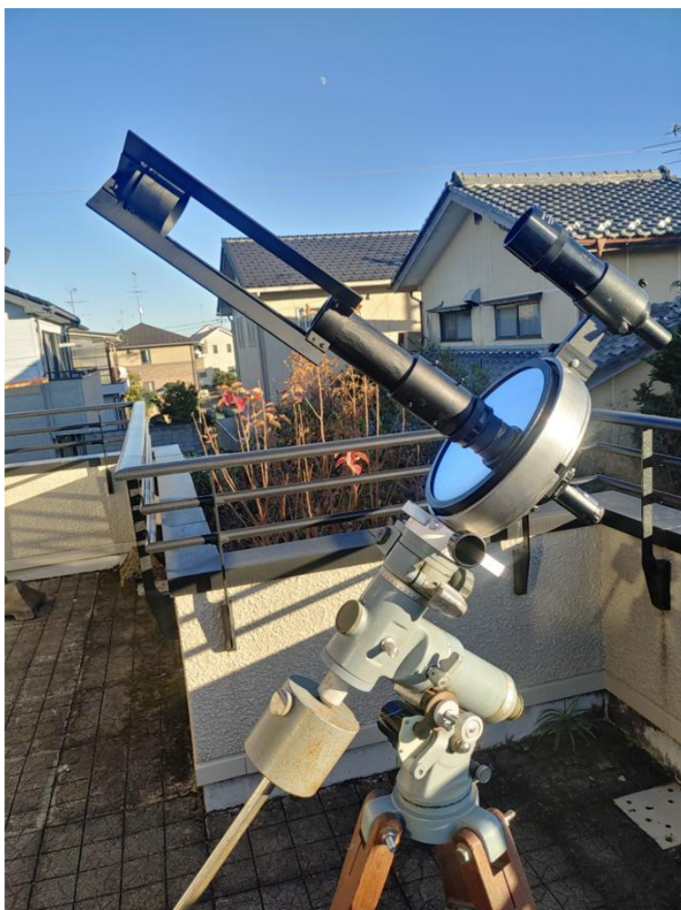
クラシカルカゼグレン 20 cm、主鏡 F3, 合成 F12、バッフルを兼ねた副鏡の 支えは 3D プリンター製
