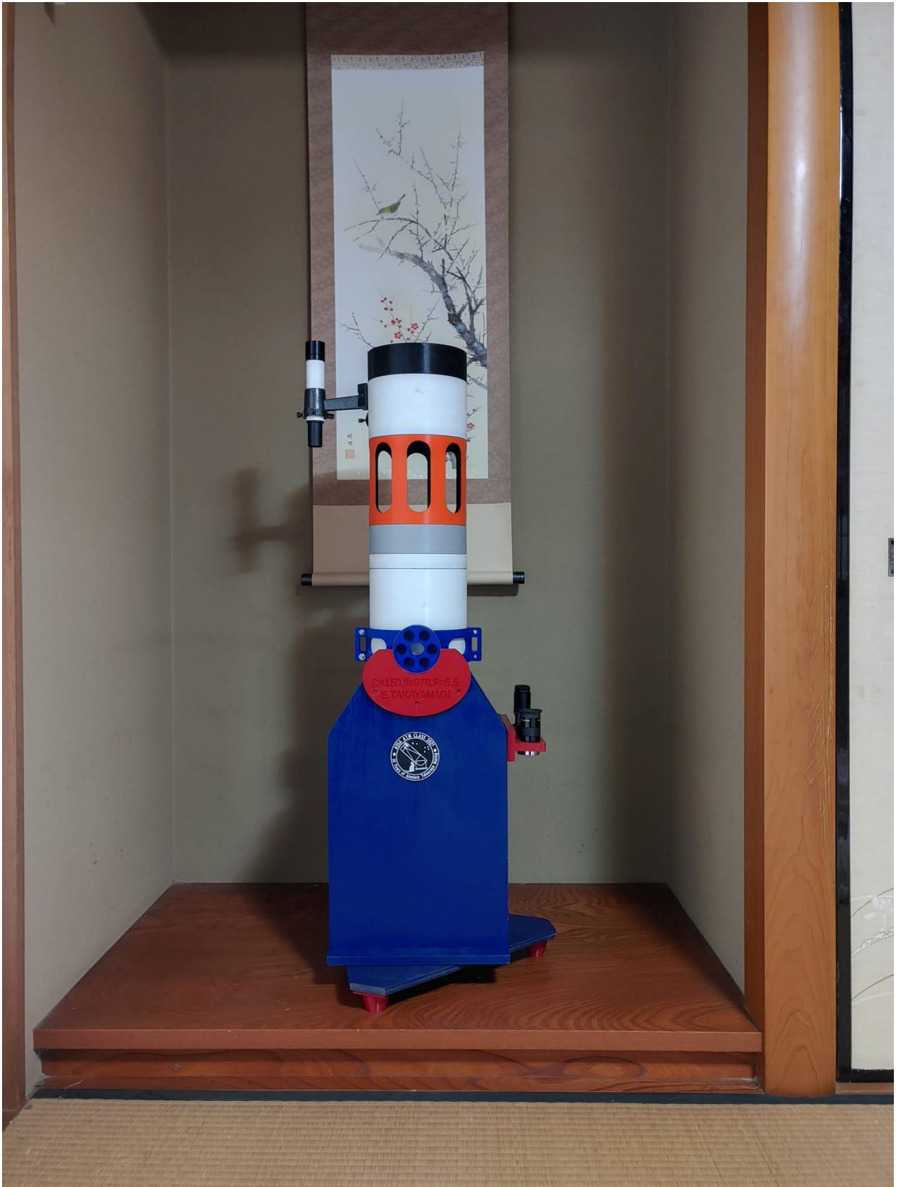
3D プリンターにより製作した望遠 鏡の1号機 (15cm,F7)
