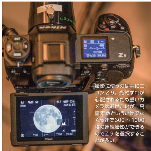
撮影に使うのは主にニコン Z9。光軸ずれが心配されるため重いカメラは避けたいが、高画素数というだけでなく高速で 300 ~ 1000 枚の連続撮影ができるので Z9 を選択することが多い。
